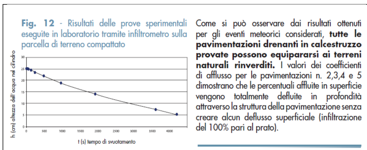
Fig. 2.2: Esiti dello studio sulle pavimentazioni drenanti
